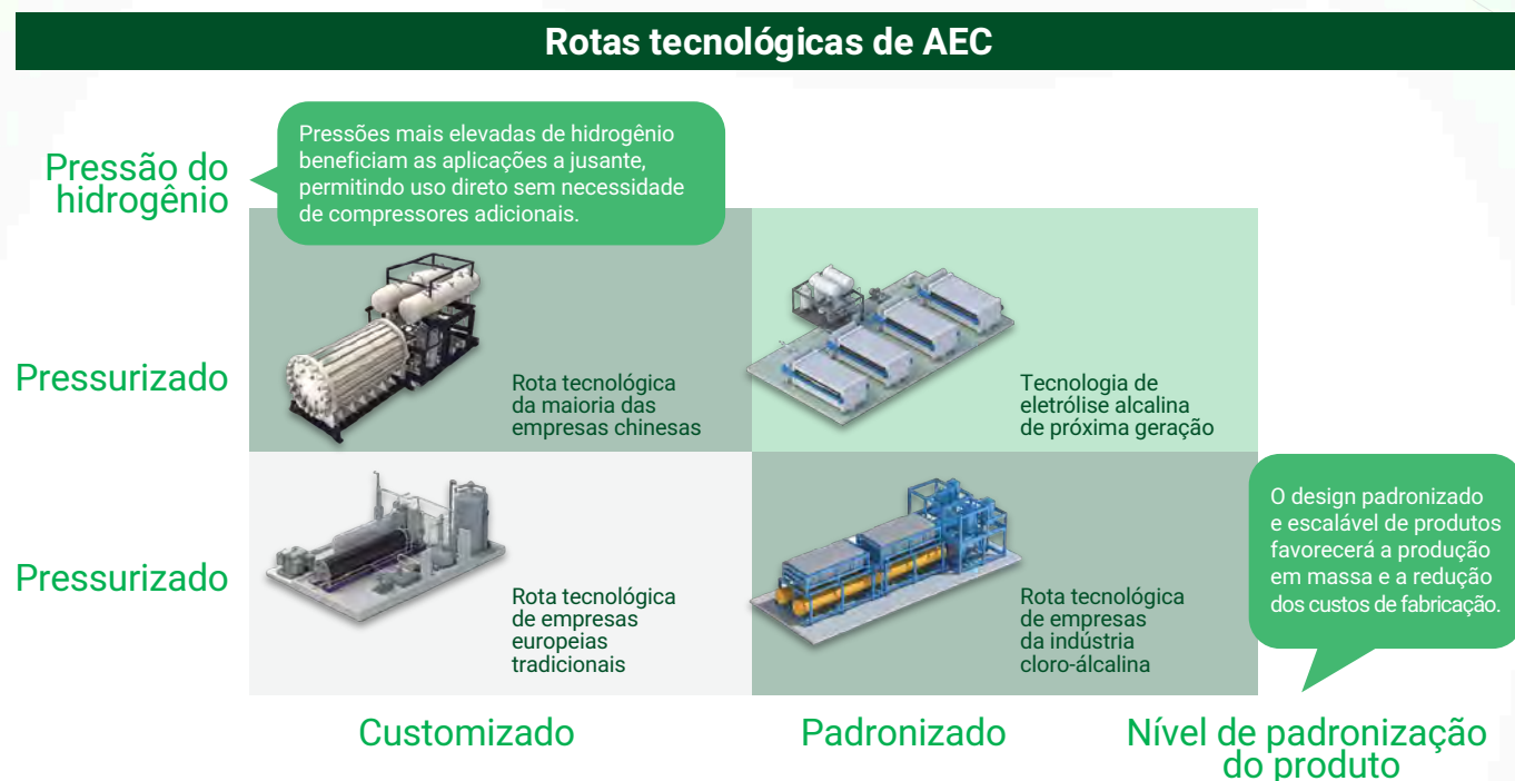
Figura 9. Rotas tecnológicas da eletrólise alcalina para produção de hidrogênio verde. Adaptado de [2].
